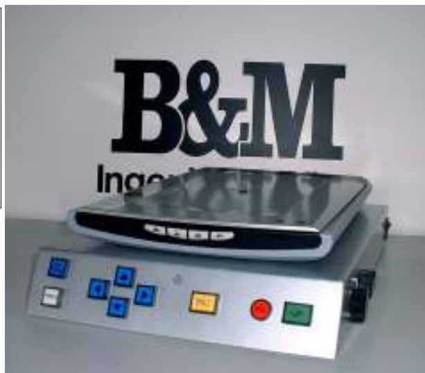
B&M Dokuphon II mit Flachbettscanner
